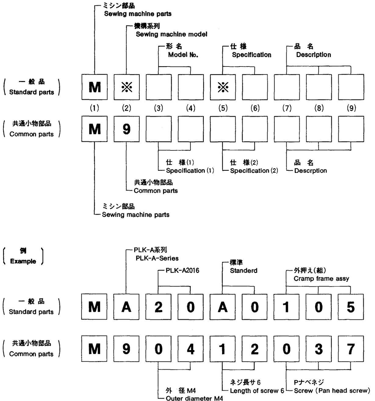
注：一般品についての機種形名は、その部品が最初に使用された機種形名を示します。従って長期に亘る場合は、機種の変更が行われるため、当初の機種以外の機種で使用されている場合があります。
