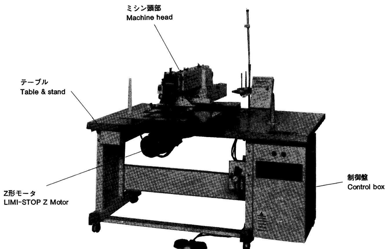
注1：モータ部分は三菱リミストップZクラッチ：モータの部品カタログ(P-007B)を参照ください。
